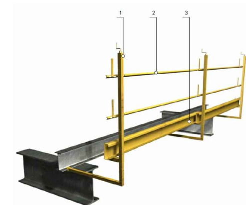
1- Guardacuerpos telescópico de seguridad fabricado en acero de 35x35mm y 1500mm de longitud. 2- Barandilla para guarda cuerpos matricada, de tubo de acero de 25mm de diámetro y 2500mm de longitud. 3- Rodapié metálico de 3m de longitud y 150mm de altura.
