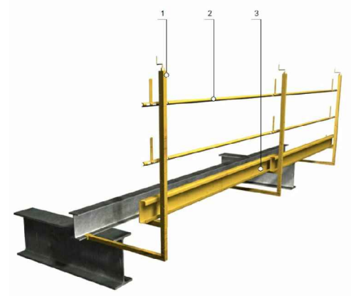
1- Guardacuerpos telescópico de seguridad fabricado en acero de 35x35mm y 1500mm de longitud. 2- Barandilla para guarda cuerpos matricada, de tubo de acero de 25mm de diámetro y 2500mm de longitud. 3- Rodapié metálico de 3m de longitud y 150mm de altura. YC005 DETALLE PROTECCIÓN BORDE, CLASE A
